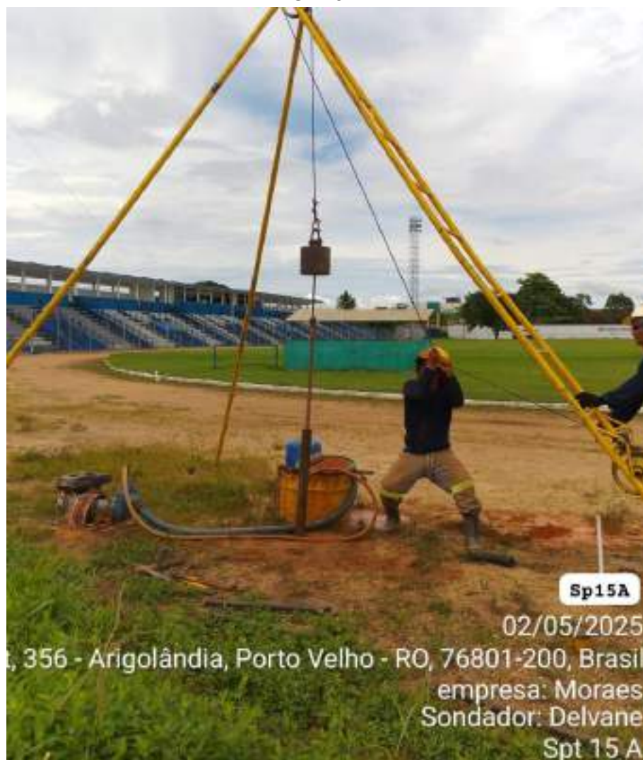
Instalação do furo SP-15 A
