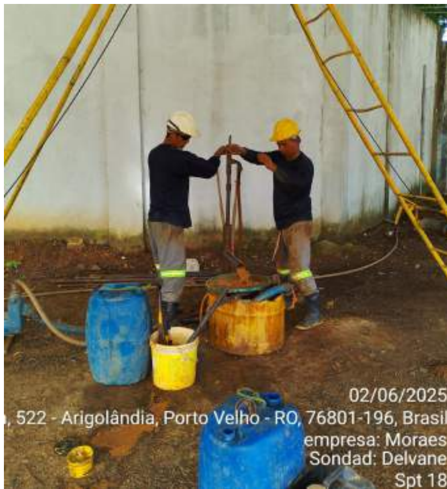
Instalação do furo SP-18
